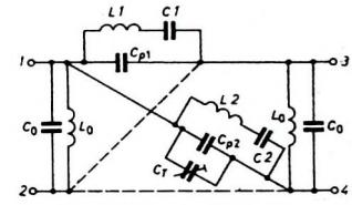
Bild 10. Vereinfachte Ersatzschaltung eines Quarzfilters
