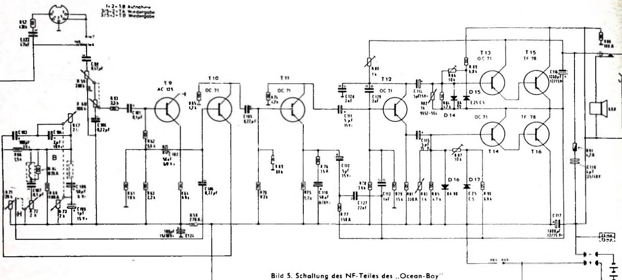
Bild 5. Schaltung des NF-Teiles des „Ocean-Boy“
