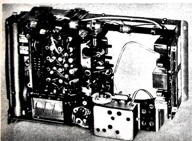
Bild 7. Blick auf das Vertikalachassis des „Ocean-Boy“; alle Abgleichpunkte sind gut zugänglich. In der Aussparung rechts läßt sich das große Ovalausstellersystem gut unterbringen
