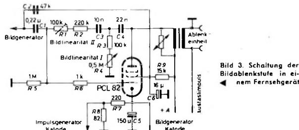
wurden zunächst die einzelnen Bauelemente des Gegenkopplungsweiges. Bei dieser Überprüfung konnte festgestellt werden, daß Kondensator C 4 am Anodenanschluß der PCL 82 eine sogenannte kalte Lötstelle hatte. Die Gegenkopplung war ausgefallen.
