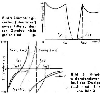
Bild 4. Dämpfungsverlauf (idealisiert) eines Filters, dessen Zweige nicht gleich sind
