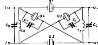
Bild 12. Vollständige Schaltung des Quarz-Brückenfilters
