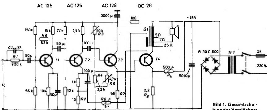
übertrager)  $U_1$  mit niedrigem Gleichstromwiderstand. Sie hat eine Induktivität von  $60 \text{ mH}$ , womit sich eine untere Grenzfrequenz von  $60 \text{ Hz}$  ergibt. Für den Anschluß von Lautsprechern mit  $5$  und  $7 \text{ Ohm}$  Impedanz sind zwei Anzapfungen vorhanden.  $U_1$  wirkt dann als Sparübertrager.
