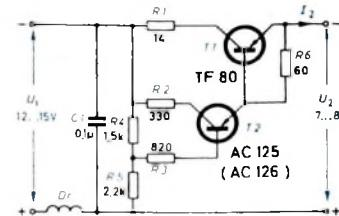
Bild 1. Schaltung des 12-V-Transistoren-Vorsatzes für den Kofferempfänger „twentie“
