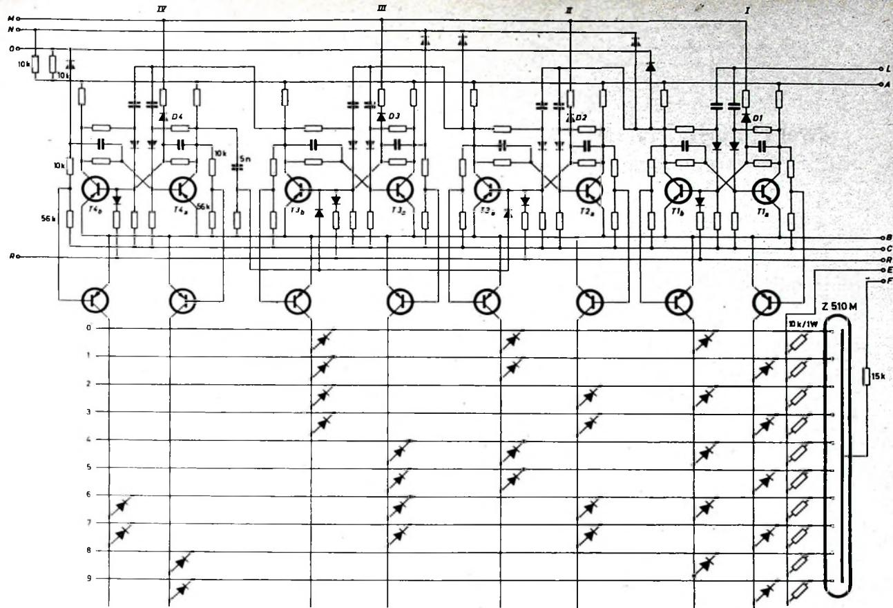
Bild 17. Schaltung des Stunden-Einers
