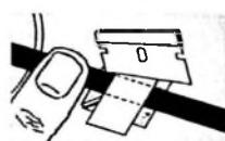
Bild 6. Überstehendes Klebeband wird abgeschnitten. Die Innenkanten der Klebeschiene dienen dabei als Führung
