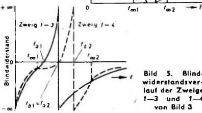
Bild 5. Blindwiderstandsverlauf der Zweige 1-3 und 1-4 von Bild 3
