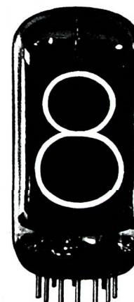
Die VALVO-Ziffern- und Zeichenanzeigeröhren sind gasgefüllt und haben kalte Kathoden in der Form der Ziffern von 0 bis 9 (Z 520 M, Z 522 M und Z 523 M) und der Zeichen + - ~ A V Ω % (Z 521 M). Die Röhre Z 523 M, die für biquinär codierte Zähler entwickelt wurde, besitzt im Gegensatz zu den andern Typen 2 Anoden; der einen sind die geradzahligen und der anderen die ungeradzahligen Ziffern zugeordnet. Außerdem sind jeweils eine geradzahlige und eine ungeradzahlige Kathode zusammenge schaltet.
