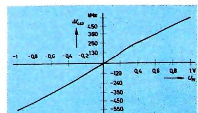
Bild 4. Nachstimmspannung an der Diode BA 102
