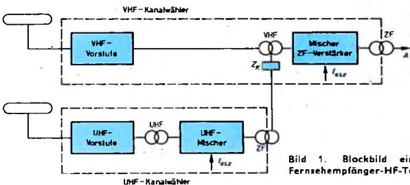
Bild 1. Blockbild eines Fernsehempfänger-HF-Teils
