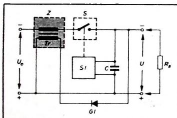
Bild 4. Gleichspannungskonstanthalter mit einem Transformator als strombegrenzendem Element
