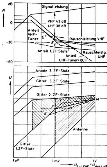
Bild 4. Regel- und Rauschverhalten eines Fernsehgerätes; Leistungen an der Videodiode (oben) und Spannungen an verschiedenen Punkten des Empfängers (unten) in Abhängigkeit vom Eingangssignal
