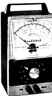
Technische Daten: Frequenzgang: ± 1 dB bei 10 Hz...500 kHz; ± 2 dB bei 10 Hz...1 MHz; Meßbereiche: 0...10, 30, 100, 300 mV, 1, 3, 10, 30, 100, 300 Veff; Netzanschluß: 220 V / 50 Hz / 10 W; Maße: 190 x 120 x 115 mm; Gewicht: 1,7 kg.
