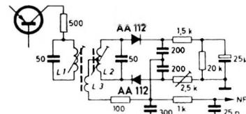
Bild 1. Schaltung des Ratio-Füllers für 10,7 MHz mit den niederohmigen Dioden AA 112
