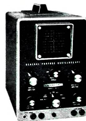
Technische Daten: Verstärker: X - Y (2 dB von 2 Hz...200 kHz); Empfindlichkeit: 0,25 Veff Raster-Teilung: Eingangsimpedanz: 10 MΩ 20 pF; 7 cm-Kathodenstrahlröhre: 3 RP-1 mit kontrastreichem, abnehmbarem Meßstrahl; Netzanschluß: 220 V / 50 Hz / 40 W; Maße: 245 x 170 x 255 mm; Gewicht: 4,2 kg.
