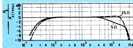
Bild 2. Frequenzgang des Verstärkers: ausgezogene Kurve 5-Ohm-Abschluß ( $P_o = 1,2$  W) und gestrichelte Kurve 25-Ohm-Abschluß ( $P_o = 0,24$  W) bei konstanter Eingangsspannung (für beide Fälle gilt gleiche Collectorspannungsaussteuerung im Maximum)
