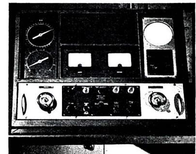
Blick auf die Anzeige- und Steuereinheit des Windmeßradars „C.R. 353“ von Cossor
