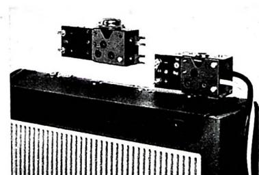
Bild 3. Autohalterung des „twentie“ mit dem 12-V-Vorsatz (oben links)
